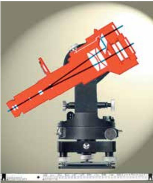
Abb. 24b: Optikschemata des Redta 002
