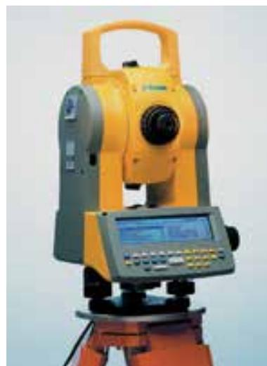
Abb. 37a: Trimble 3600 mit Elta CU
