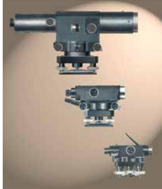
Abb. 3: Zeiss-Libellennivelliere, entwickelt 1949 – 1953
