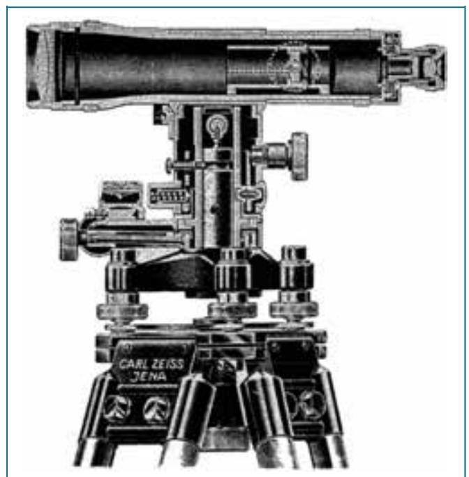
Abb. 1b: Nivellier I – Schnittdarstellung
