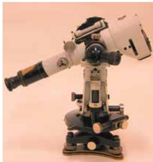
Abb. 23: Reduktionstachymeter Redta II
