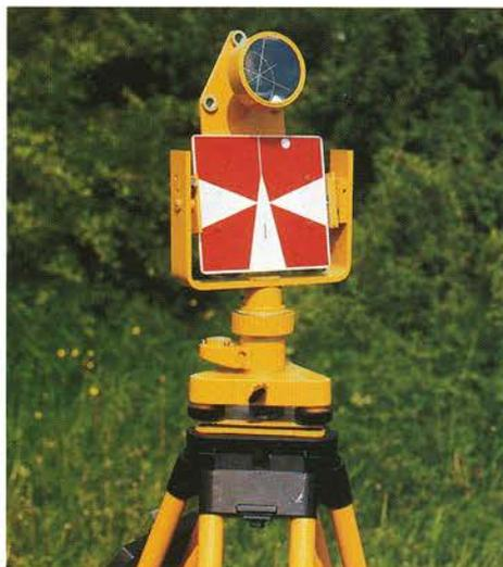
Das neue Reflektorsystem zum AEM 1200 ist auf das Zieltafelsystem der Theodolit-Typenreihe B und das Tachymeterstativ aus Jena abgestimmt.
