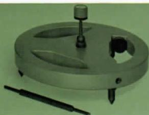
Soll der Theodolit auf einem Pfeiler aufgestellt werden, so befestigt man ihn auf dem schweren **Pfeileruntersatz**, den man vorher mittels eines Zentrierstifts mit Dosenlibelle genau zentriert.
