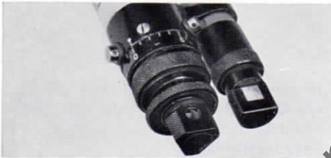
Für Steilzielung (das Fernrohr erlaubt solche bis zu  $65^\circ$  über den Horizont) kann je ein **Okularprisma** auf Fernrohrökular und **Ablese-Mikroskop** aufgeschraubt werden. Für Sonnenbeobachtungen dient ein dunkles **Sonnenglas** zum Okularprisma.
