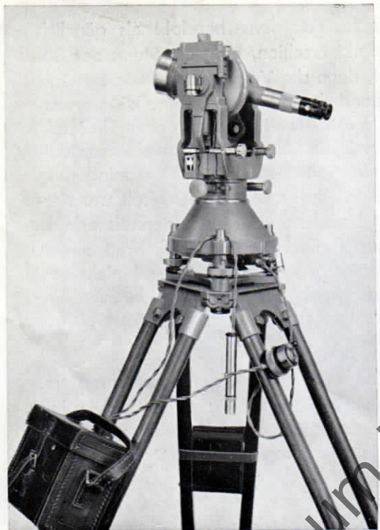
Fig. 3 Präzisions-Theodolit WILD T3 mit elektrischer Beleuchtung und Handlampe
